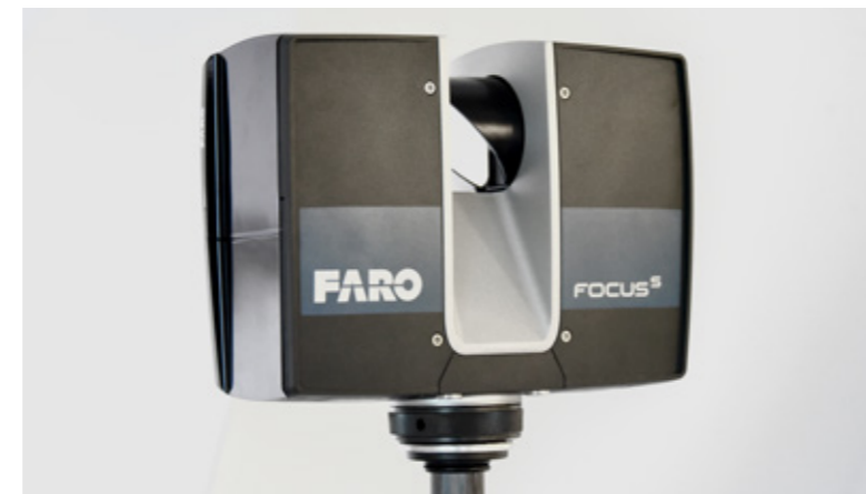
3-D-Scanner zur exakten räumlichen Erfassung der Unfallstelle
